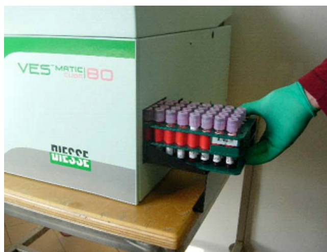
Рис. 11. Правая сторона Ves-Matic Cube 80 (загрузка штатива с пробами)
