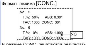
В режиме CONC. печатаются результаты светопропускания, абсорбции, концентрации и значение фактора.
