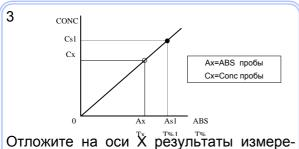
Отложите на оси X результаты измерения пробы, для определения концентрацию соотнесите с осью Y.
