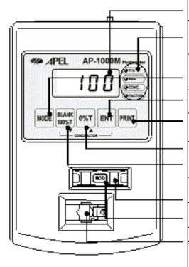
ЖК-дисплей: Дисплей показывает светопропускание Т%, абсорбцию Abs, концентрацию Conc и фактор Factor.
