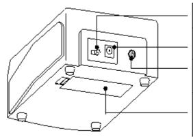
Выключатель ON/OFF: Выключение/включение прибора.
