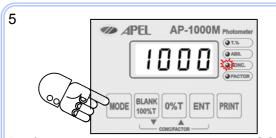
Выберите режим концентрации CONC кнопкой MODE, после измерения абсорбции согласно пунктам 5-1, 5-2, для расчета фактора.
