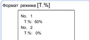
В режиме 1% печатаются измеренные результаты коэффициента светопропускания.
