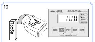
На дисплее появятся результаты измерения %Т или ABS только после того, как кювета с пробой будет размещена в измерительной камере.
